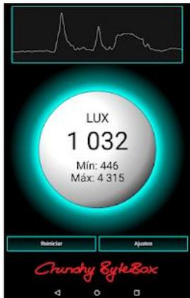
Es posible conocer el nivel de iluminación por medio de aplicaciones gratuitas que utilizan los sensores integrados de muchos teléfonos celulares. Basta buscar la palabra clave “luxímetro o luxómetro”, una vez instalada y abierta, posicionar el teléfono sobre la superficie de trabajo para verificar la cantidad de luz con la que estamos trabajando.
